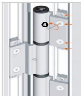
Alle bevestigingsschroeven van het bovenste kaderdeel lossen.
