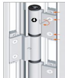
Alle bevestigingsschroeven van het bovenste kaderdeel vast zetten.
